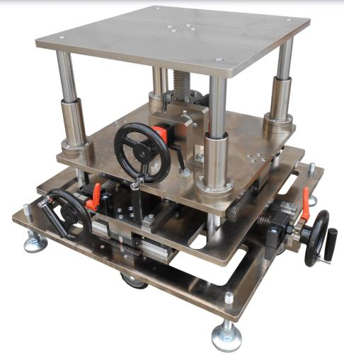
X軸ストローク: ±50mm ハンドル1回転5mm 1mm単位メジャー目盛り付き Y軸ストローク: ±50mm ハンドル1回転5mm 1mm単位メジャー目盛り付き
